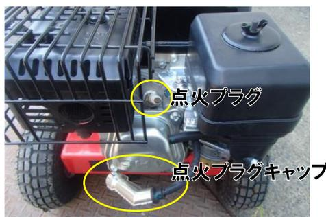
付属の工具(プラグレンチ)で、点火プラグを取り外します。
