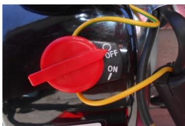
燃料供給レバーを左の方向にスライドさせます。
