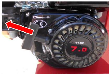
⑥エンジン始動後にアクセルレバーの開度を調整してください。(亀マーク側がアクセル最小絞り状態)
