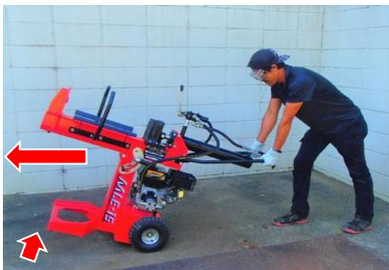
移動させるときは、薪割り機を横置きにし、移動用ハンドルで前方を浮かせて押して移動させます。
