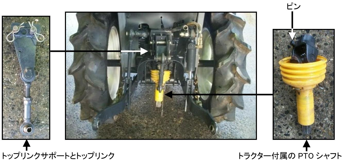
本機に使用するトッリンクは、必ず 55cm 程度の長尺トッリンクを使用してください。
