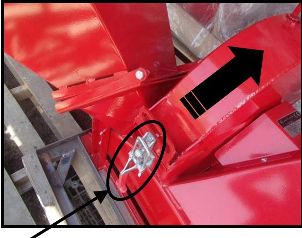
ロックを外し、矢印の方向に保護カバーを開けて下さい。
