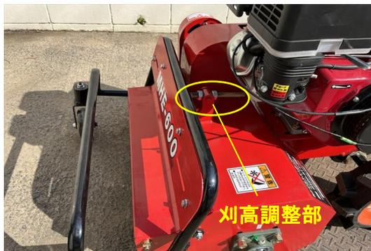
写真上の固定用ナットを緩めてから調整ナットを回してください。
