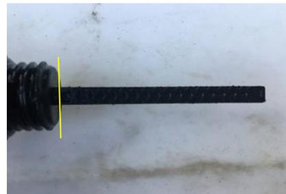
給油栓についているレベルゲージでエンジンオイルの質・量を毎回作業前に点検してください。
