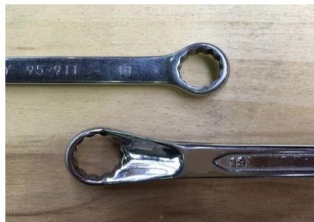
替刃を取り付けしているボルトとナットのサイズはボルト【18】ナット【19】です。
