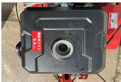
燃料キャップを外し、燃料を確認して下さい。
