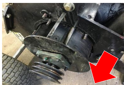
⑦ブレード付ホイールの取外し
