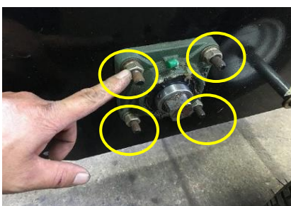
⑤ベアリングカバーの取外し
