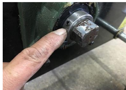
⑥ベアリングの取外し
