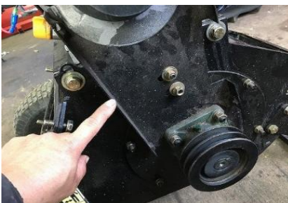
④ベルトパネルの取外し
