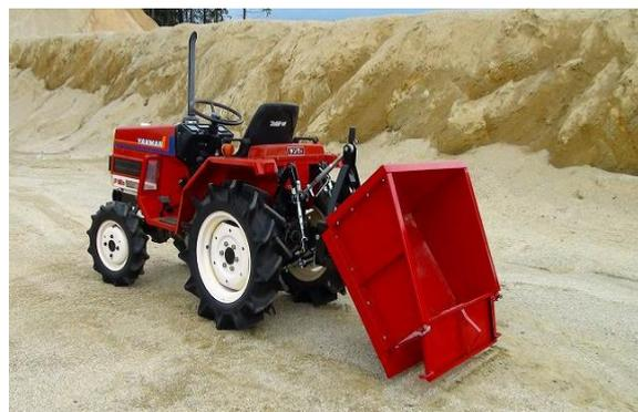
トラクターの後方に取付けて、土砂や肥料の運搬、ダンプ機能を生かして除雪作業にも大活躍です。
